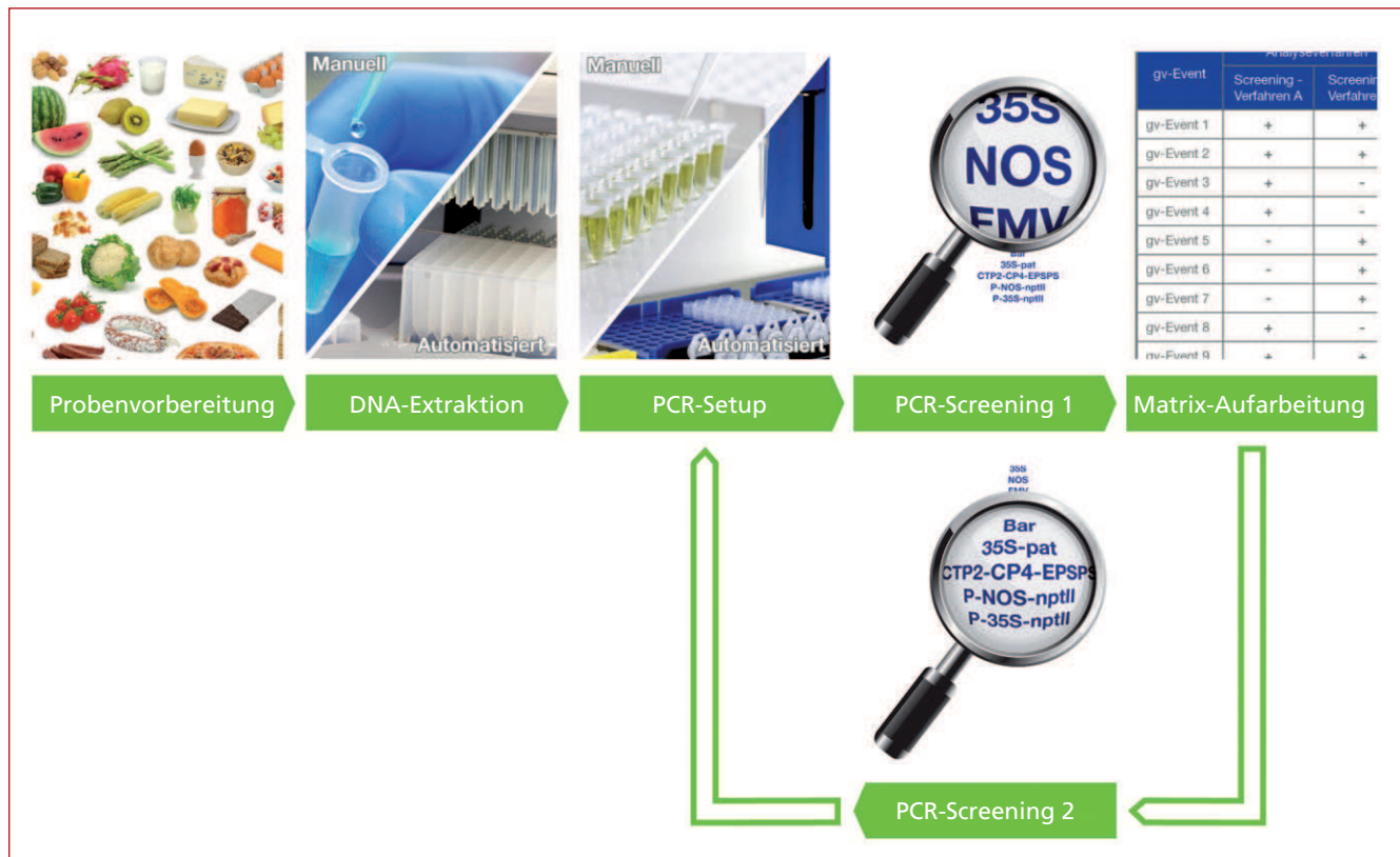
Abb. 3 Ablauf eines GVO-Screenings mit validierten Kitsystemen: Nach Abwiegen und Homogenisieren der Probe kann die Automation manuell (Spinfilter-Saulchen) oder automatisiert (Magnetic Beads) erfolgen. Das PCR-Setup kann ebenfalls von Hand oder von einem Roboter pipettiert werden, wobei lyophilisierte Multiplex-Kits hier den Aufwand besonders bei manueller Bearbeitung erheblich reduzieren. Ein Basisscreening auf P-35S, T-NOS und P-FMV kann fur positive Proben nach Auswertung mit der Matrix noch mal durch eine weitere Screening-Runde mit anderen Markern erweitert werden.
